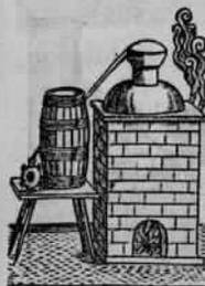
Le contient la veffie d'airain couuverte d'un alembic d'airain, le bec duquel perce un trouneau de bois plein d'eau froide, afin que les esprits ne s'evanouissent en l'air, ains qu'ils soient condensez. Et couuverts en eau. Par cet alembic (comme dit est) on distille l'eau de vie. Les apotecaires d'Allemagne presque tous distillent ainsi leurs eaux de toutes plantes.
