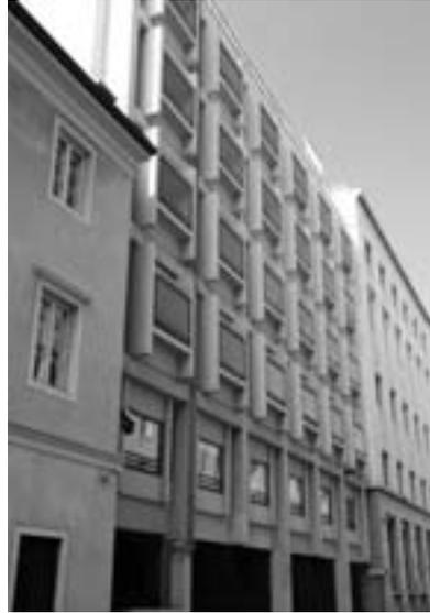
Fig. 13 – Palazzo dell'Italcantieri (1964): destinato agli uffici è stato realizzato con criteri riferibili all'architettura razionalistica, connotato da moduli rapportati distributivamente, strutturalmente e figurativamente agli ambienti interni. Anche in questo palazzo l'Autore indulge su motivi formali neoplastici.
